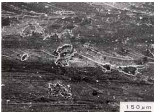
Fig.5 腐食部の電子顕微鏡写真
